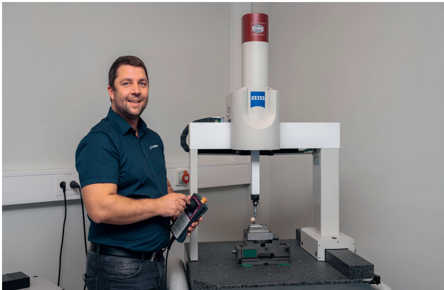
Die Kombination aus modernisiertem Koordinatenmessgerät Zeiss Vista und der aktuellen Messsoftware 'U-Soft Solid ultra 7' läuft heute besser denn je © Schneider Messtechnik
